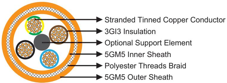
**Insulation:** EPR type 3GI3.
